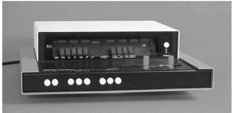
FIGURA 8-47 El puente digital se usa para medir de manera precisa resistencia, inductancia y capacitancia.
