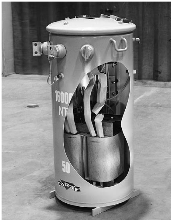
FIGURA 23-3 Transformador de distribución (vista de corte) del tipo que emplean las compañías eléctricas para distribuir potencia a usuarios domésticos y comerciales. El tanque está lleno de aceite para mejorar el aislamiento y evitar el calentamiento del núcleo y los devanados. (Cortesía de Carte International Inc.)
