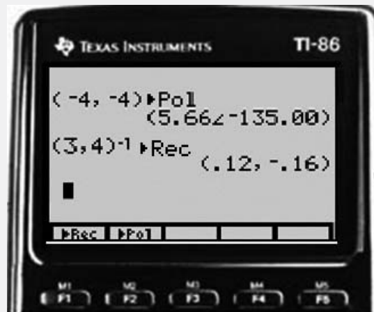
FIGURA 16-6 Despliegue de números complejos en la TI-86. Observe que los resultados polares se muestran en la notación estándar, pero los rectangulares no.
