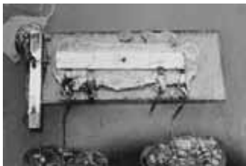
El primer circuito integrado, un oscilador de desplazamiento de fase, inventado por Jack S. Kilby en 1958. (Cortesía de Texas Instruments).
